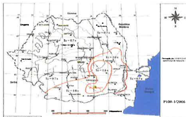
Perioada de control (colț) a spectrului de răspuns T_c
