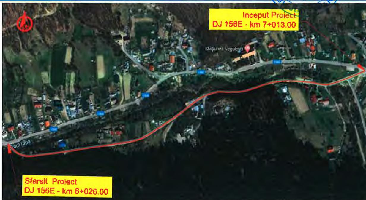
Traseul proiectat urmareste, in general, traseul existent cu realizarea corectiilor care s-au impus datorita largirii platformei existente respectiv prin adoptarea elementelor geometrice corespunzatoare adaptate la situatia din teren.
