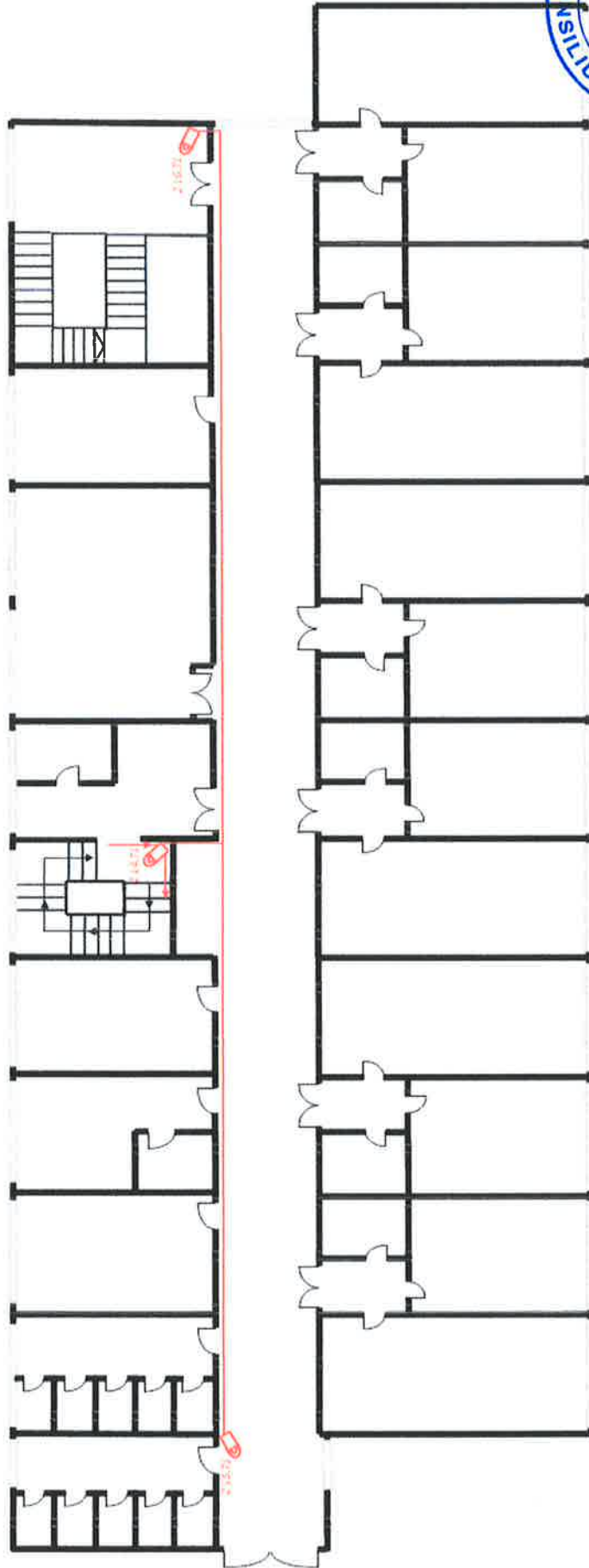
B2.2. Schita sistemului de alarmare la efracție – Corp C1, Tronson 1 - Plan Etaj 1
