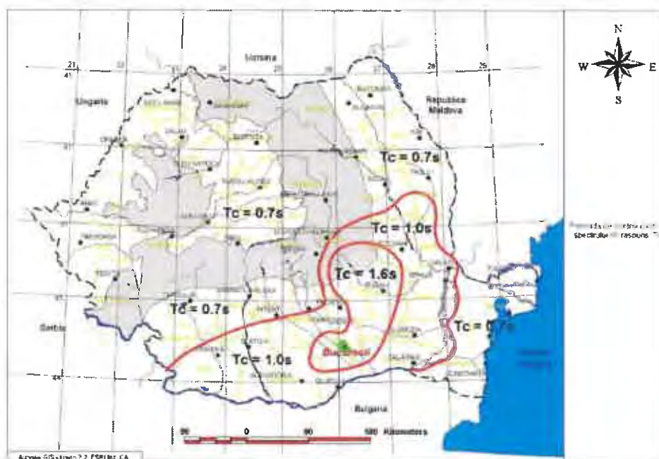
Zonarea teritoriului României în termeni de perioadă de control (colt) T_c a spectrului de răspuns CONDITII CLIMATICE
